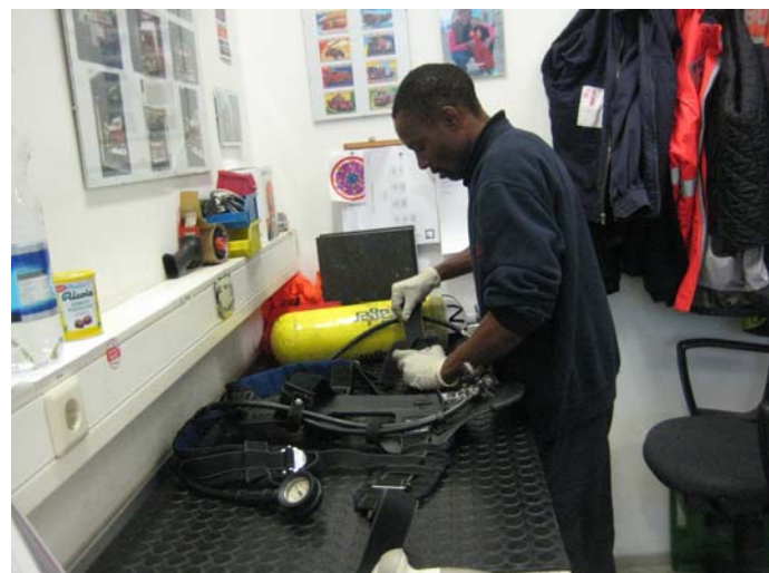
Montage des neuen Atemschutzgerätes
